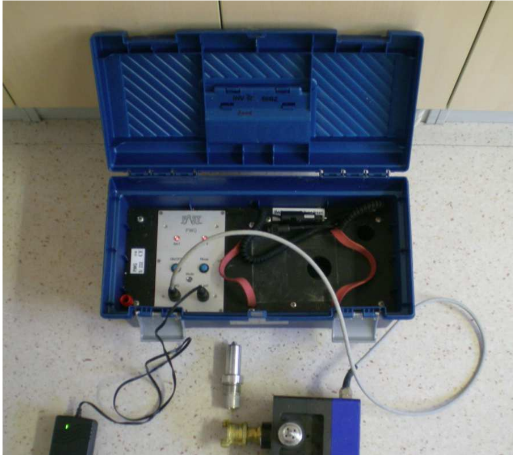
Slika 6: Iskalec cevovodov PWG-2 (KSP Litija d.o.o.)
