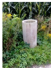
Vrtina za vzorčenje podzemne vode
