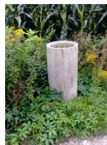
Vrtina za vzorčenje podzemne vode
